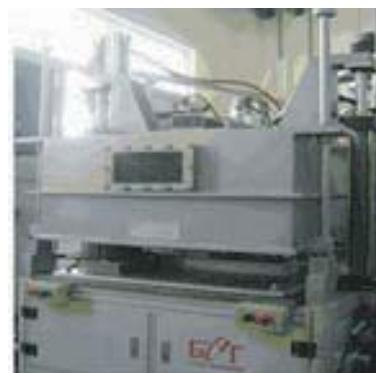
以更省力、更自動化的設計理念，為您量身打造讓操作更方便，更有效率，圖示為油壓升降式真空槽。
