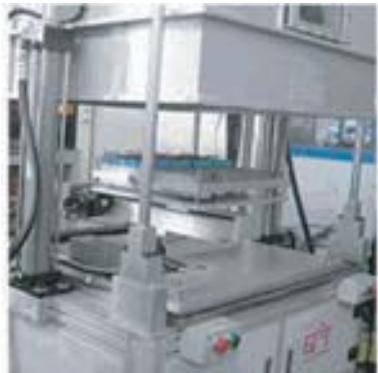
真空槽內可加裝各種運動定位裝置，以提升產能，圖示為真空槽內加上X-Y雙向位移定位元裝置。
