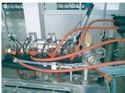
國瀚獨特設計之真空灌注閥，以最前端為吐出口，灌注無殘膠飛濺，為真空，充填專用。
