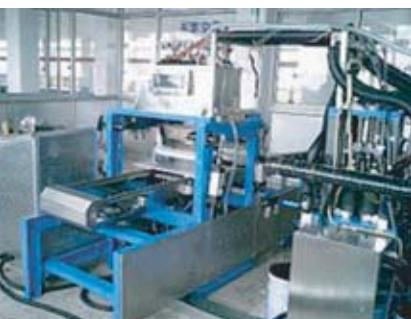
方型真空箱，灌注閥充填過程看得見，密封機能良好，真空維持度佳，可維持高真空度，避免空氣混入。
