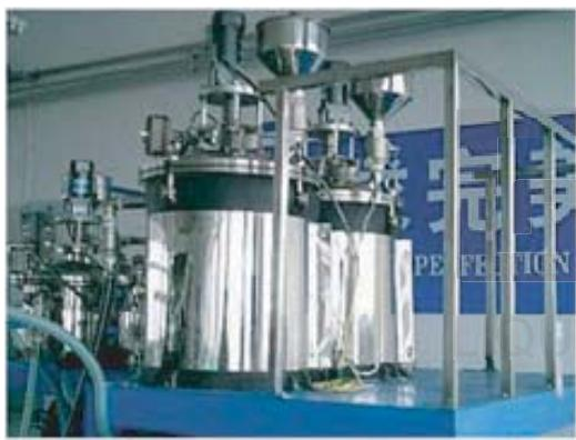
儲膠桶採用高安全性之不鏽鋼製成，可耐高真空，高壓力，密閉性，耐久性良好，以電動攪拌方式拌勻樹脂，加強脫泡功能，並有液位元警示裝置。
