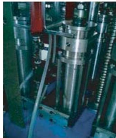
採用活塞式，柱塞式，齒輪式高精密容積計量，不因黏度變化影響計量以及比例精度。
